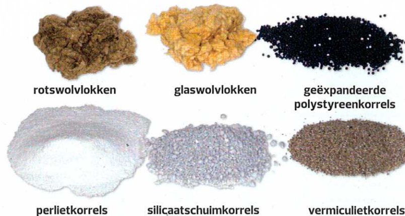
Uiteindelijk lopen de thermische prestaties van nageïsoleerde spouwmuren niet echt uiteen, ongeacht het isolatiemateriaal dat wordt gebruikt.
